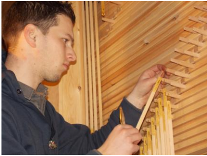
Montage overbrenging toetsen aan wellenbord
