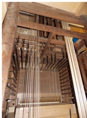
Mechaniek in kas hoofd-voor toetsen en registers
