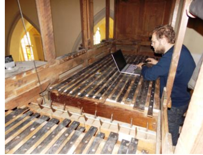
Vrijliggende slepen hoofdwerk, maten worden ingetekend
