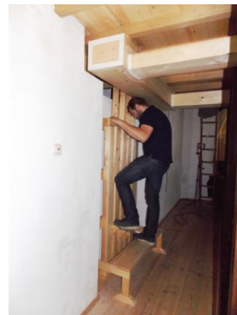
Tussentijdse controle door Wim Diepenhorst v.d. Rijksdienst Klinkend erfgoed hierbij gebruikmakend van z.g. "getreden wind", dit kan normaal ook electrisch.
